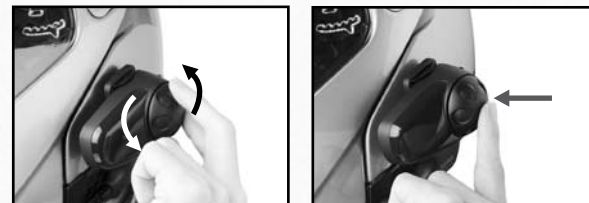
JogDial Multifunktionskopf drehen und/oder drücken
