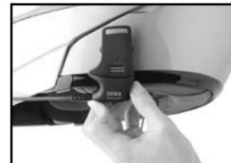
2. Richten Sie das Mikrofon bitte so aus, dass die **dreieckige Markierung** auf dem Mikrofon in Richtung Mund zeigt.
