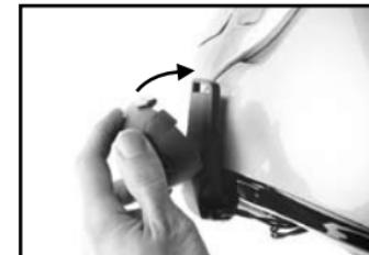
5. Pour enlever l'ensemble principal du casque de l'ensemble de fixation du haut-parleur/microphone, maintenez avec votre pouce la partie inférieure de l'ensemble de fixation du haut-parleur/microphone et appuyez doucement sur le crochet situé à la partie supérieure de l'ensemble principal du casque avec votre index jusqu'à ce qu'il soit dégagé. Il sera peut-être nécessaire d'effectuer cette opération pour recharger ou porter l'ensemble principal du casque.
