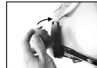
5. Um die Headset Haupteinheit von der Lautsprecher-Mikrofon Klemmeinheit zu lösen, halten Sie den unteren Teil der Lautsprecher-Mikrofon Klemmeinheit mit Ihrem Daumen und drücken Sie den Haken am oberen Teil der Headset Haupteinheit vorsichtig mit Ihrem Zeigefinger herunter bis er ausrastet. Sie können die Haupteinheit zum Beispiel lösen, um das Headset aufzuladen oder es zum Schutz vor Diebstahl mit sich zu führen.
