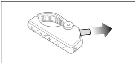
Entfernen Sie das Klebeband vom Akkufach, um mit der Nutzung der RC4 zu beginnen.
