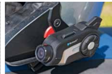
Gelungene Details allerorten: Die Steuerung mittels Drehknopf gelingt super, die drehbare Linse des 10C (links) oder die stabile Eintastenverriegelung beim 20S (rechts) zeigen, dass Motorradfahrer mitentwickelt haben.
